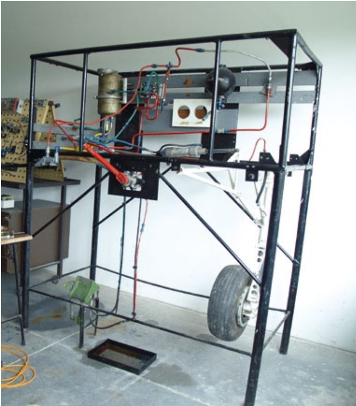
Izquierda: Sistema manual de simulación de tren de aterrizaje de tijera convencional. Derecha: Interior del simulador de cabina, en construcción.
