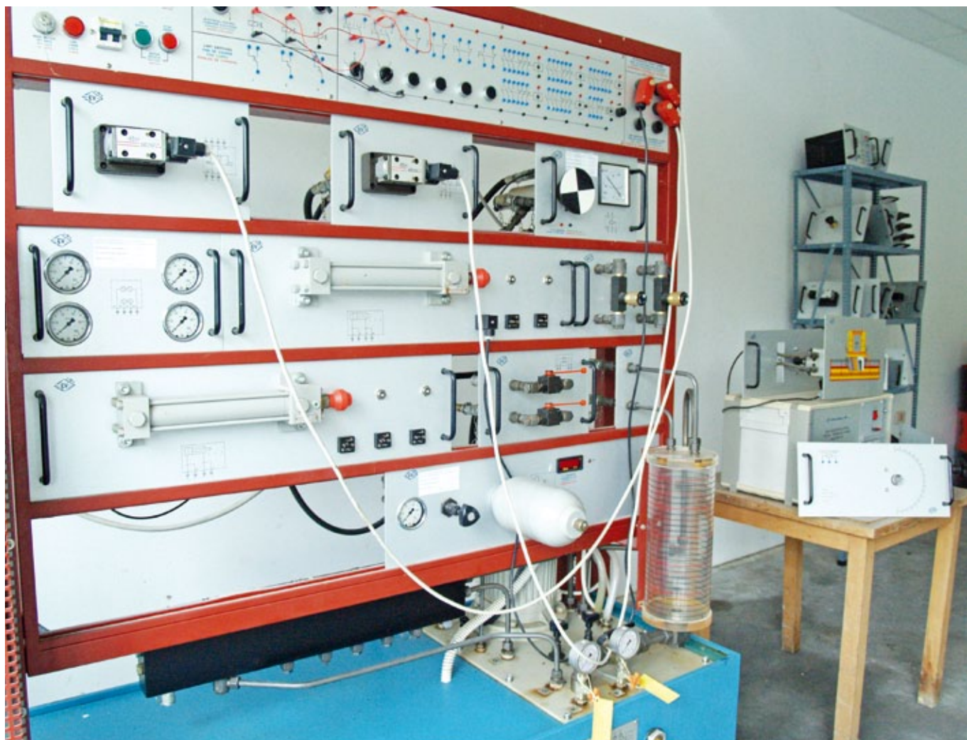
Simulador oleohidráulico utilizado en aulas prácticas. Oil hydraulic simulator used in the practical classrooms.
